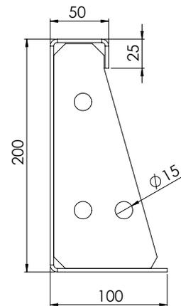
A fixer les uns aux autres par les boulons et écrous fournis.
